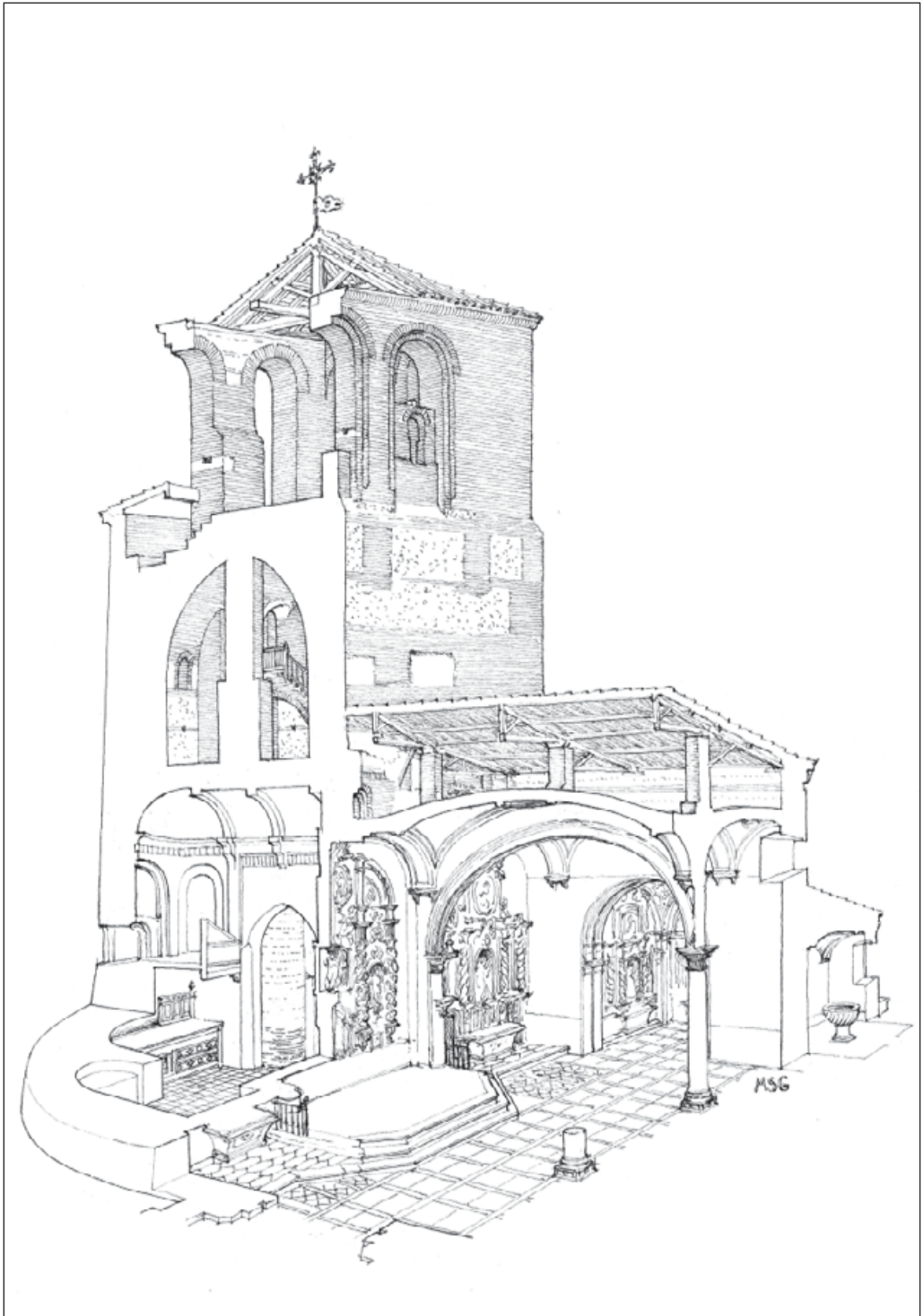
Barromán. Axonometría de la cabecera, ático, crucero y sobrecubierta. Dibujo de Miguel Sobrino
