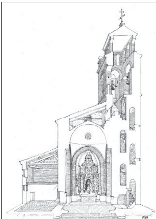
Blasconuño de Matababras. Sección de la cúpula y la torre. Dibujo de Miguel Sobrino
